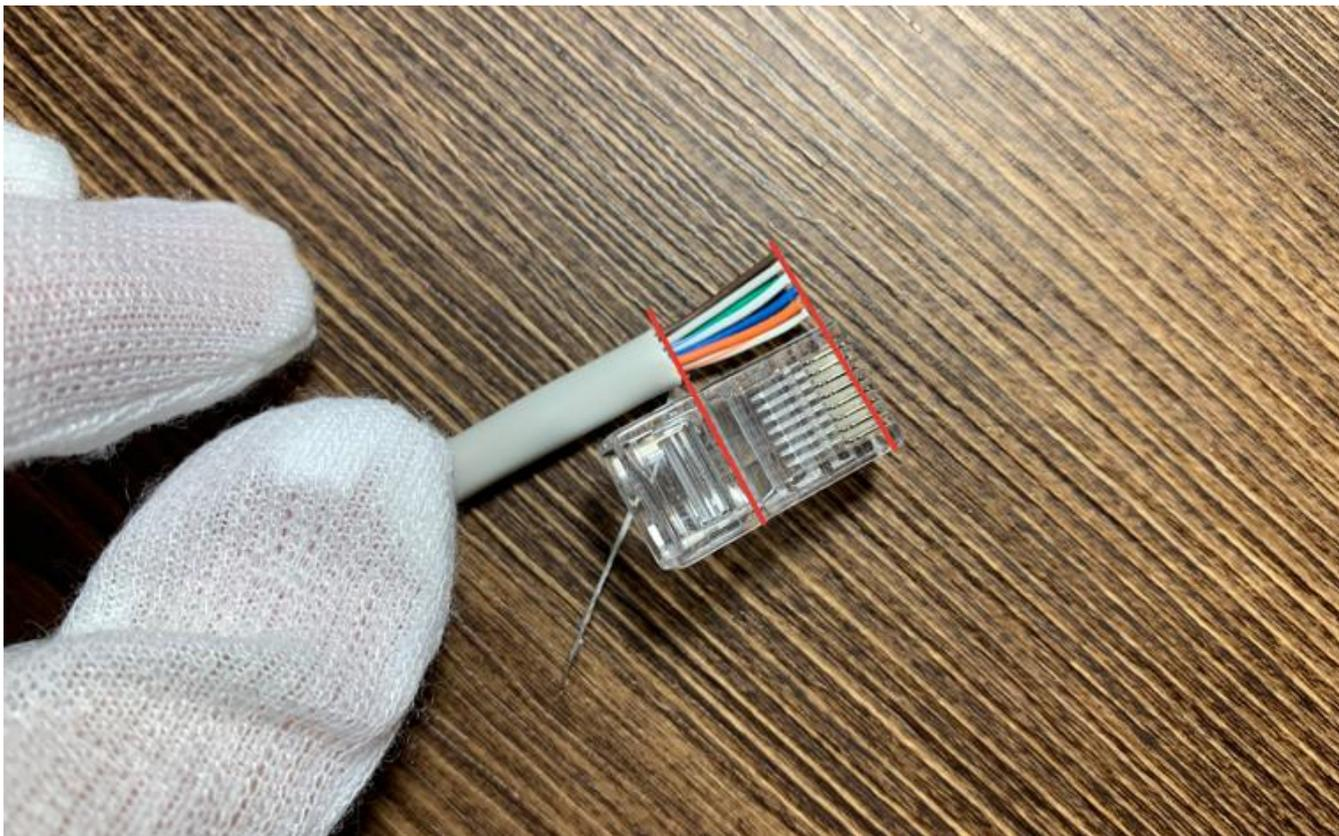
Чтобы удержать пучок в правильном порядке, можно прижать их пальцем возле края оболочки, а затем аккуратно перенести хлипкую конструкцию в коннектор. В нем есть специальные салазки для каждого провода — поэтому после того, как каждый проводник попадет на свою дорожку, просто вставляем кабель до упора. Не забываем отвести в сторону нейлоновую нить:
