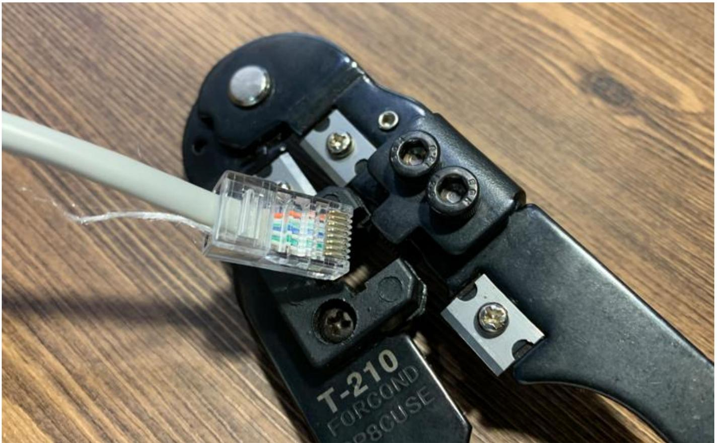
Когда коннектор окажется в правильном положении в инструменте, сжимаем ручки кримпера практически до упора, после чего будет слышен щелчок — сработает стопор оболочки в коннекторе:
