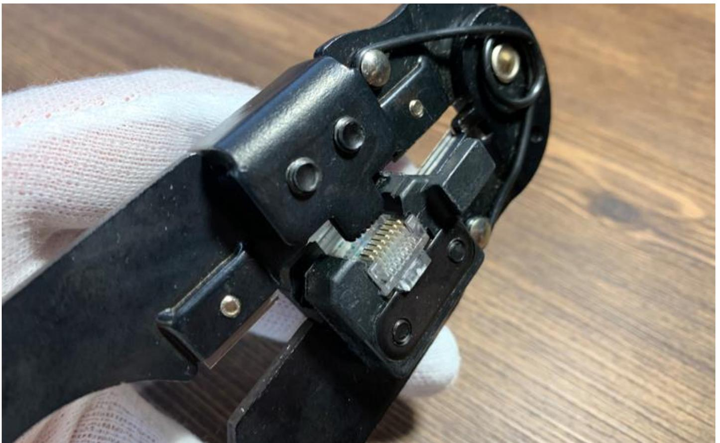
Зубцы кримпера имеют одинаковый шаг и соответствуют контактам в коннекторе. При сжатии ручек они попадают в пазы с контактами и продавливают их через оболочку проводников:
